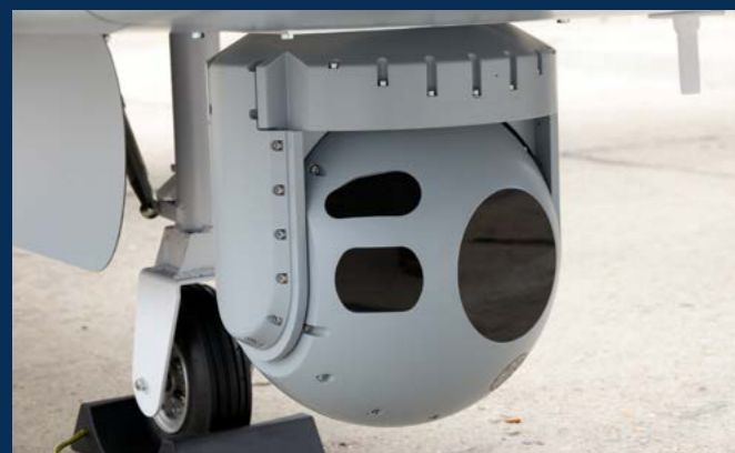
Kamerasystem einer Drohne
