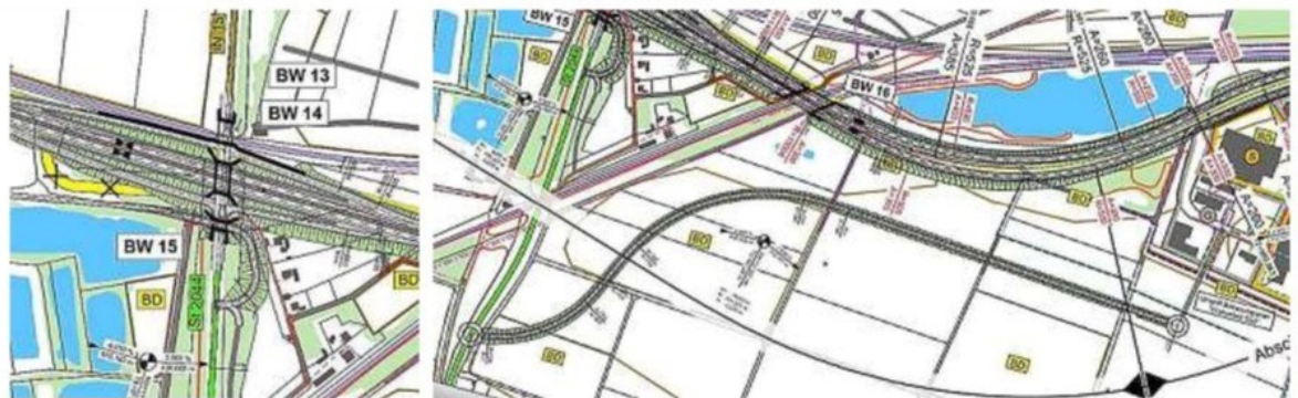
Die Brücke zum Gewerbegebiet Weierfeld soll wegfallen (oben). Der Anschluss des Ingoparks soll durch die unten eingezeichnete Parallelstraße zwischen Karlskroner Straße und Ingopark ersetzt werden (unten rechts). Die Straßenbrücke Oberstimmer Straße weiter östlich wird erneuert, die Fußgängerbrücke kann teilweise erhalten bleiben. Der Anschluss B 16/Karlskroner Straße (unten links) wird zu einer Raute mit einer Ampelanlage auf der Karlskroner Straße umgebaut und die Brücke Windener Straße weiter westlich durch einen Neubau ersetzt.
