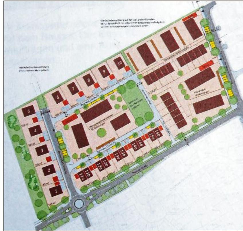
Der Plan für das Baugebiet zeigt in der Mitte die Mehrgenerationenanlage, umsäumt von den kleinen Parzellen, und rechts die beiden für Bauträger vorgesehenen Areale.
